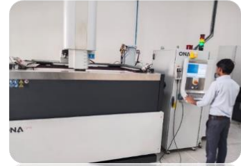
❖ CNC DIE SINKER EDM MACHINES -02 Nos
